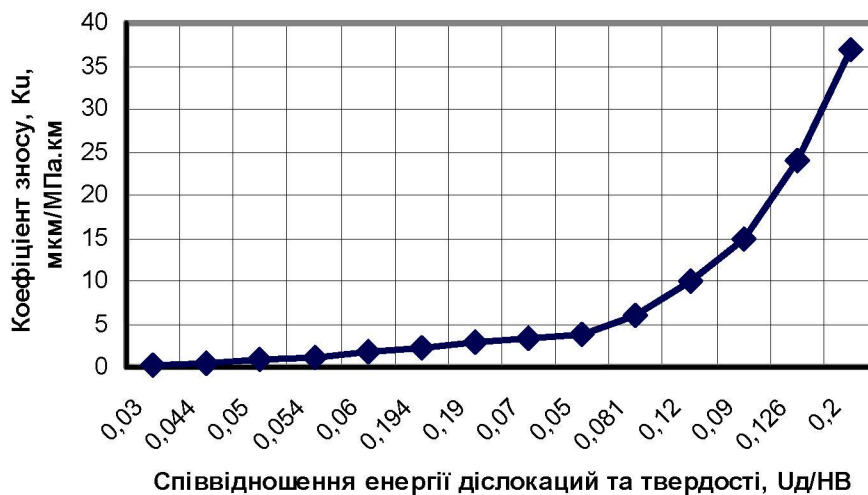
Рисунок 3 - Залежність коефіцієнта зносу K_U від співвідношення енергії дислокацій U_D до твердості складових металів H_B .
